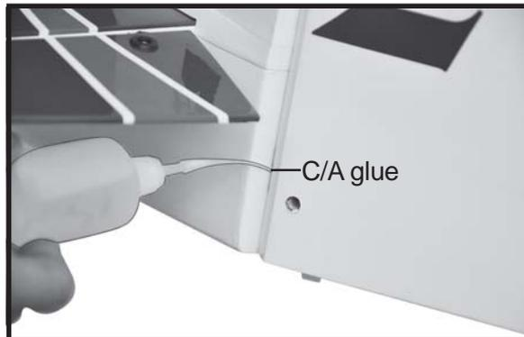
**RUDDER CONTROL HORN INSTALLATION.**
